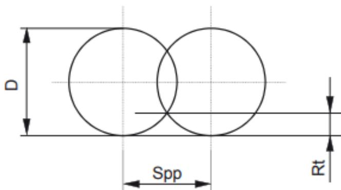
Slika 34. Linearni korak alata kružnog presjeka [2]
