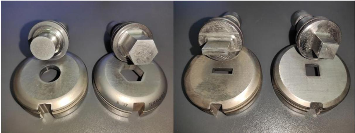
*Slika 23. Geometrije osnovnih alata [2]*
