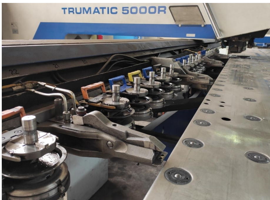
Slika 11. Linearno spremište alata
