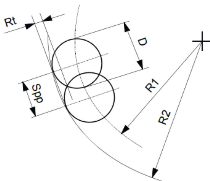
Slika 35. Kružni korak alata kružnog presjeka [2]
