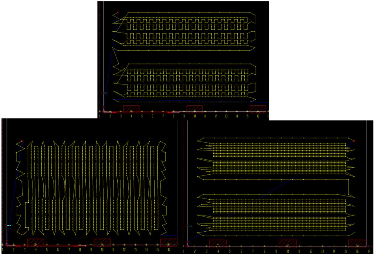
*Slika 58. Perforacija probijana alatom kružne geometrije promjera 6,8 mm*
