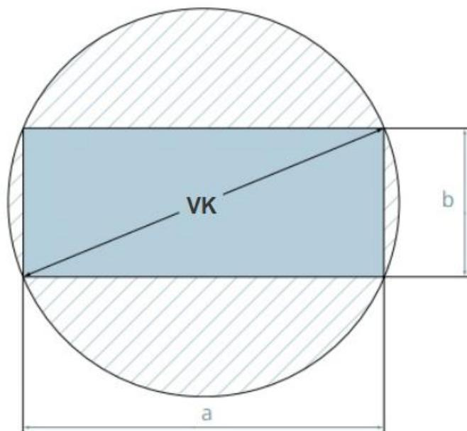
Slika 16. Vanjska kružnica alata pravokutne rezne geometrije
