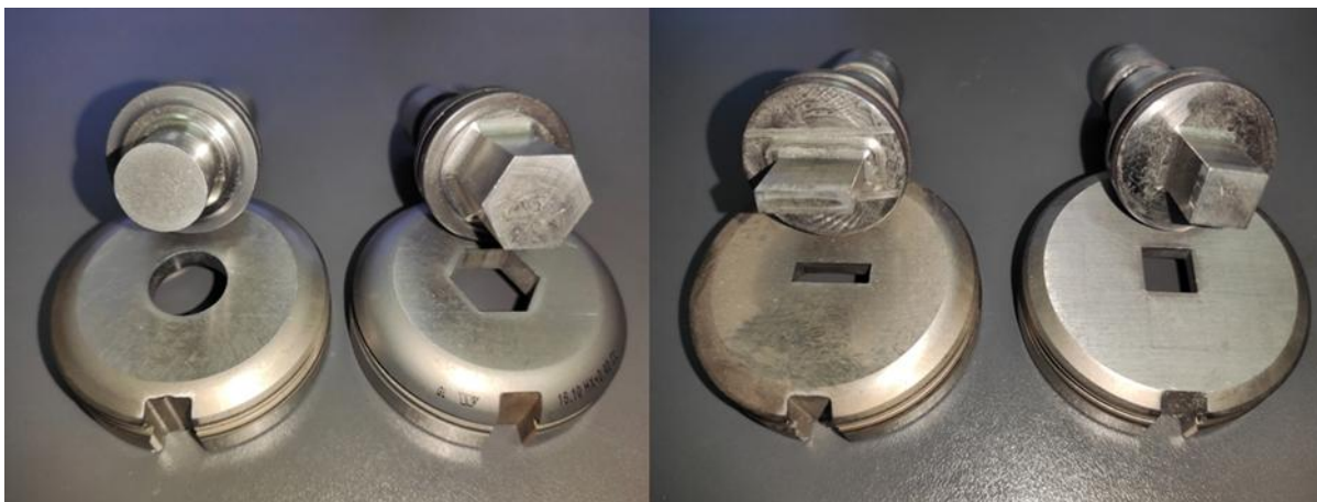
Slika 23. Geometrije osnovnih alata [2]
