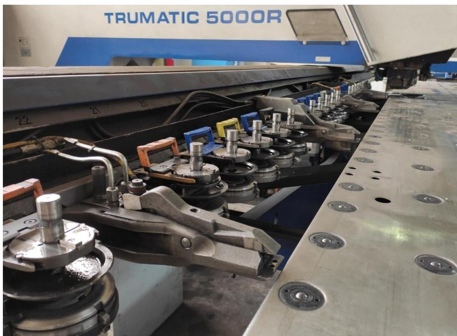
*Slika 11. Linearno spremište alata*
