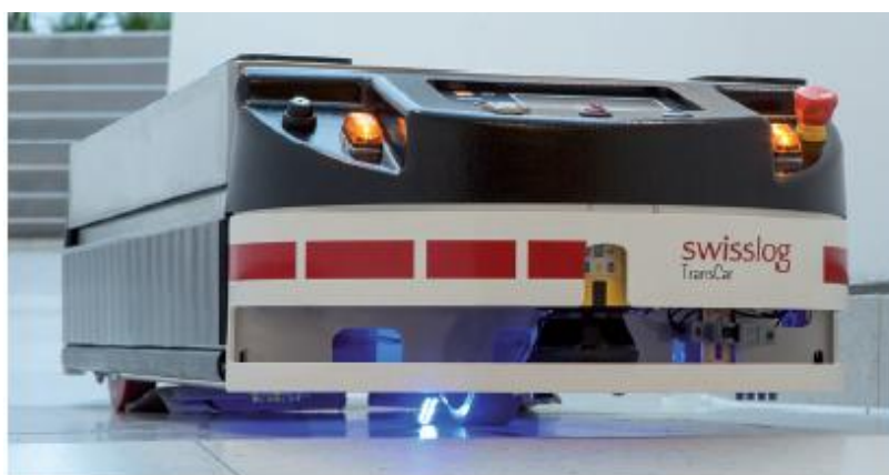
Slika 19. SWISSLOG TransCar AGV
