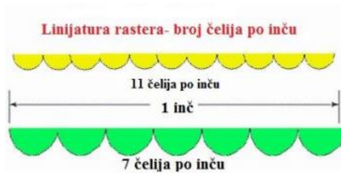
Slika 29. – Različita linijatura aniloks valjka
