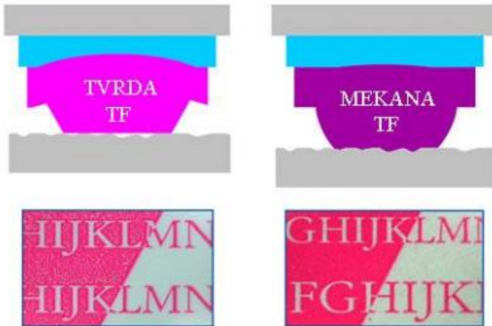
Slika 12. - Tvrda TF i mekana TF – razlika u otisku
