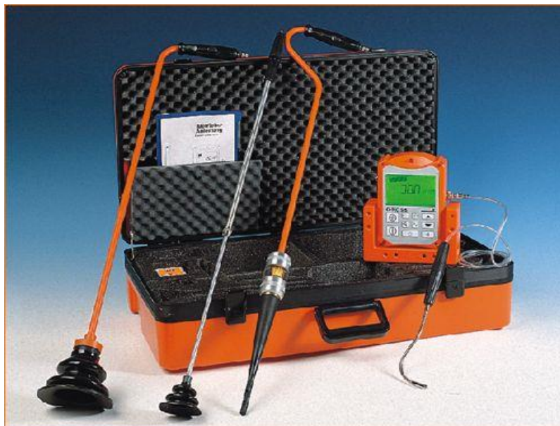
Slika 5.4 Zvonasti ispitni uređaji [8]
