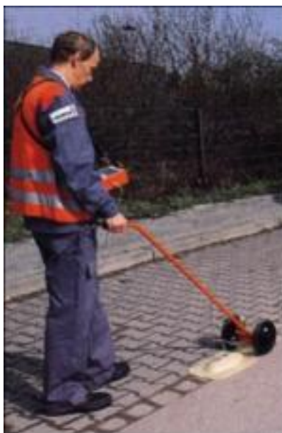
Slika 5.3 Sonda na kotačiće [8]
