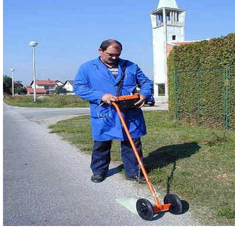
Slika 4.5 Sonda na kotačiće
