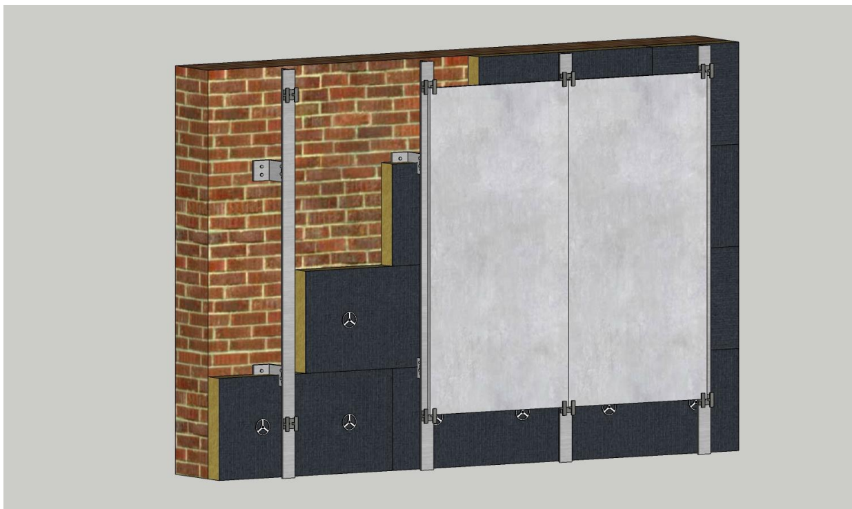
Slika 42. Model 4. Betonske fasadne ploče [18]
