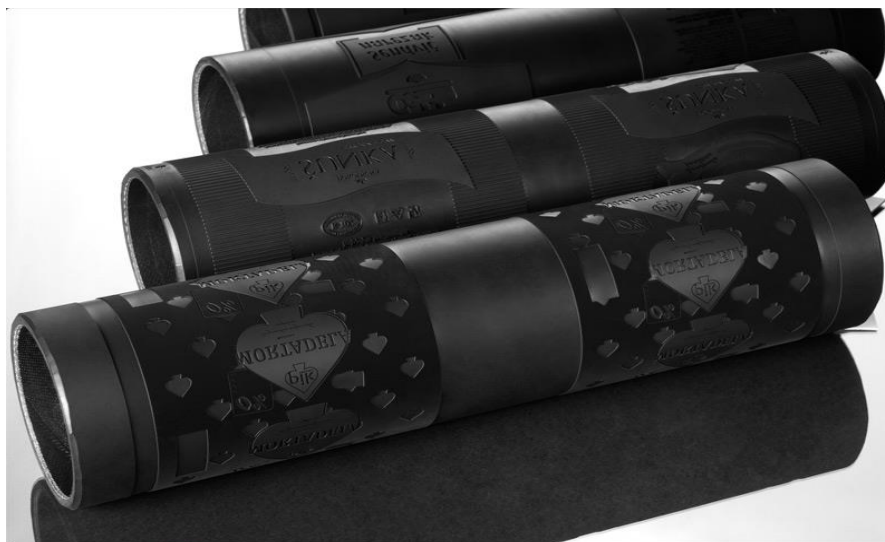
Slika 5.4 Gumena tiskarska ploča montirana na temeljni cilindar
