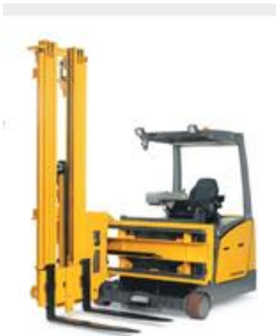
Slika 4.6.: EFX 410-413 viličar sa zakretnim vilicama [11]
