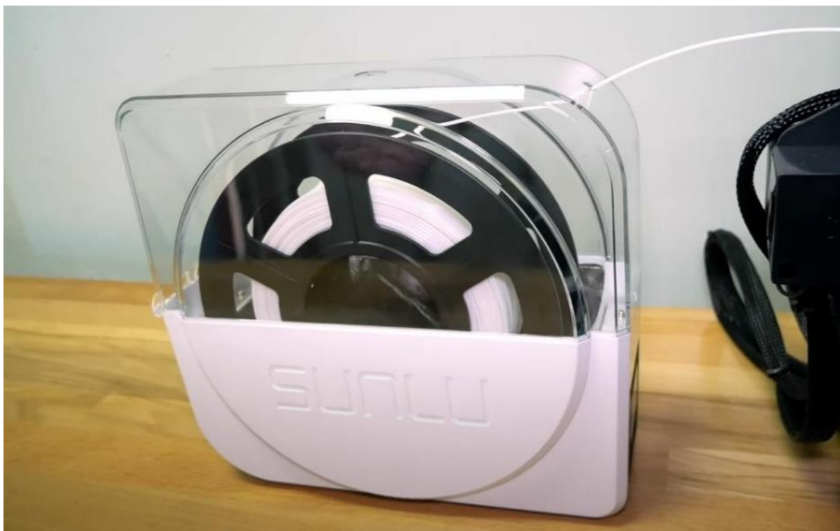
Slika 5.2.7 Sunlu FilaDryer S1 sušač filameta
