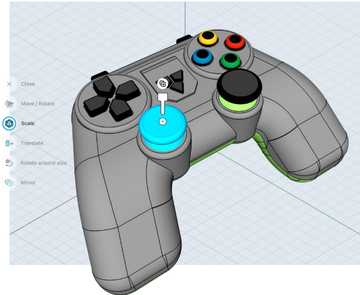
Slika 3.2.6 Primjer korištenja Shapr3Da za izradu prototipa proizvoda
