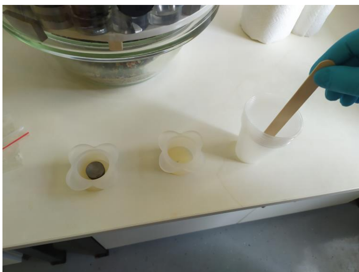
Slika 27. Pozicioniranje uzorka i ulijevanje smole u kalup
