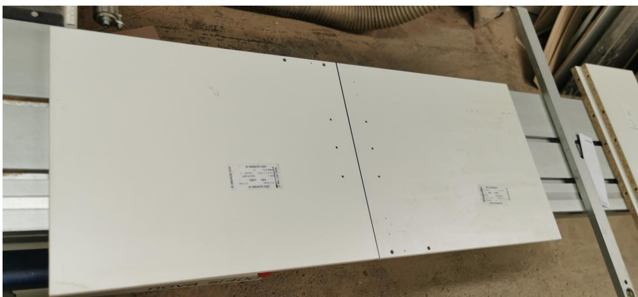
Slika 11: Provjera bušenja i pozicija kantova
