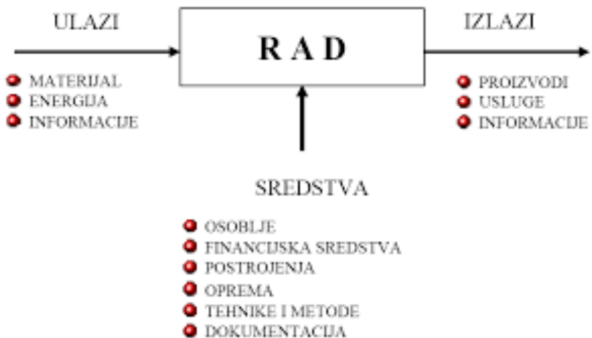
Slika 1.3. Primjer oblikovanja procesa u pripremi proizvodnje [6]
