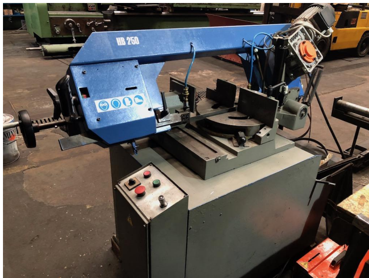
Slika 3.7 Tračna pila Adal HB 250 c [14]
