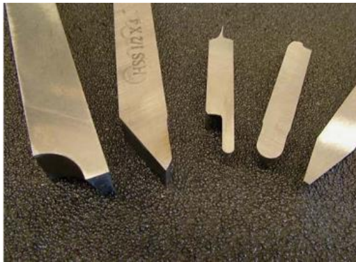
Slika 3.4 Tokarski nož od brzoreznog čelika [8]
