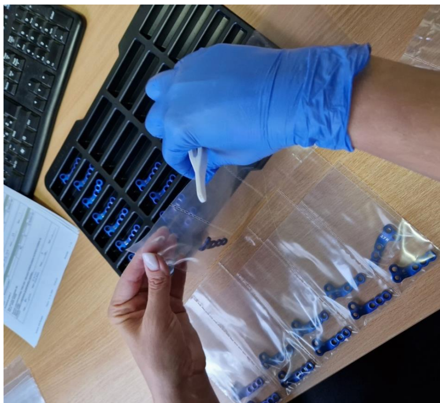
Slika 35. Pakiranje pločica u vrećice
