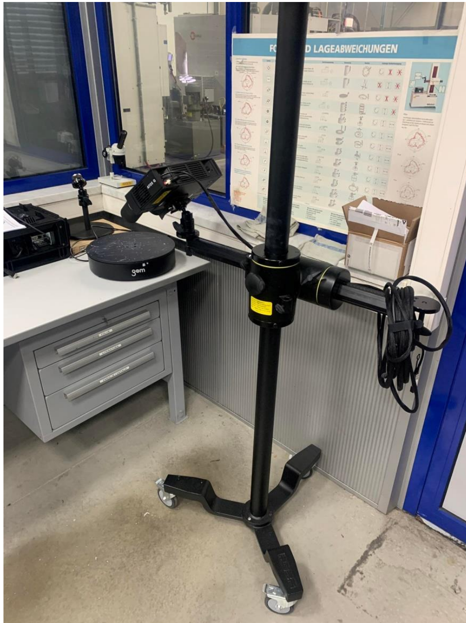
Slika 43. Skener Atos Q8 s postoljem
