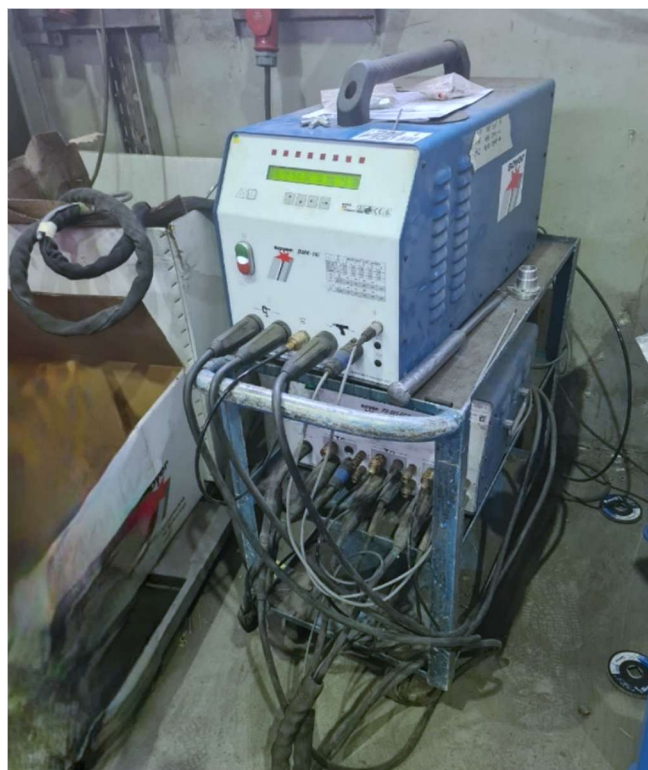
Slika 4.2. Izvor struje za zavarivanje SOYER BMK-16i Stud Welder u proizvodnom pogonu
