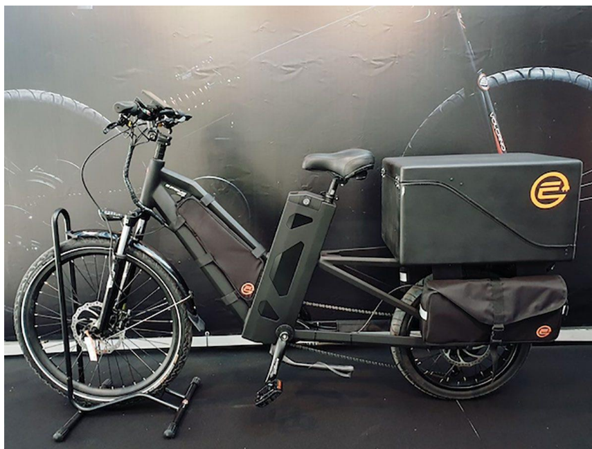
Slika 3 Teretni e-bicikl za dostavu i prijevoz robe
