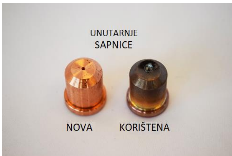
Slika 2.10 Potpuno nova unutarnja sapnica lijevo i oštećena unutarnja sapnica desno [13]
