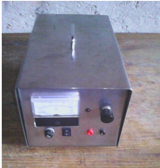
Slika 3.6 Konačni izgled ispravljača
