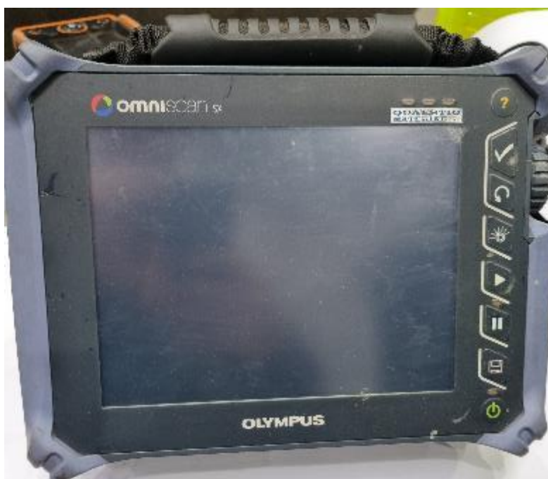
Slika 5.9 Ultrazvučni uređaj OMNISCAN SX 1664PA [28]
