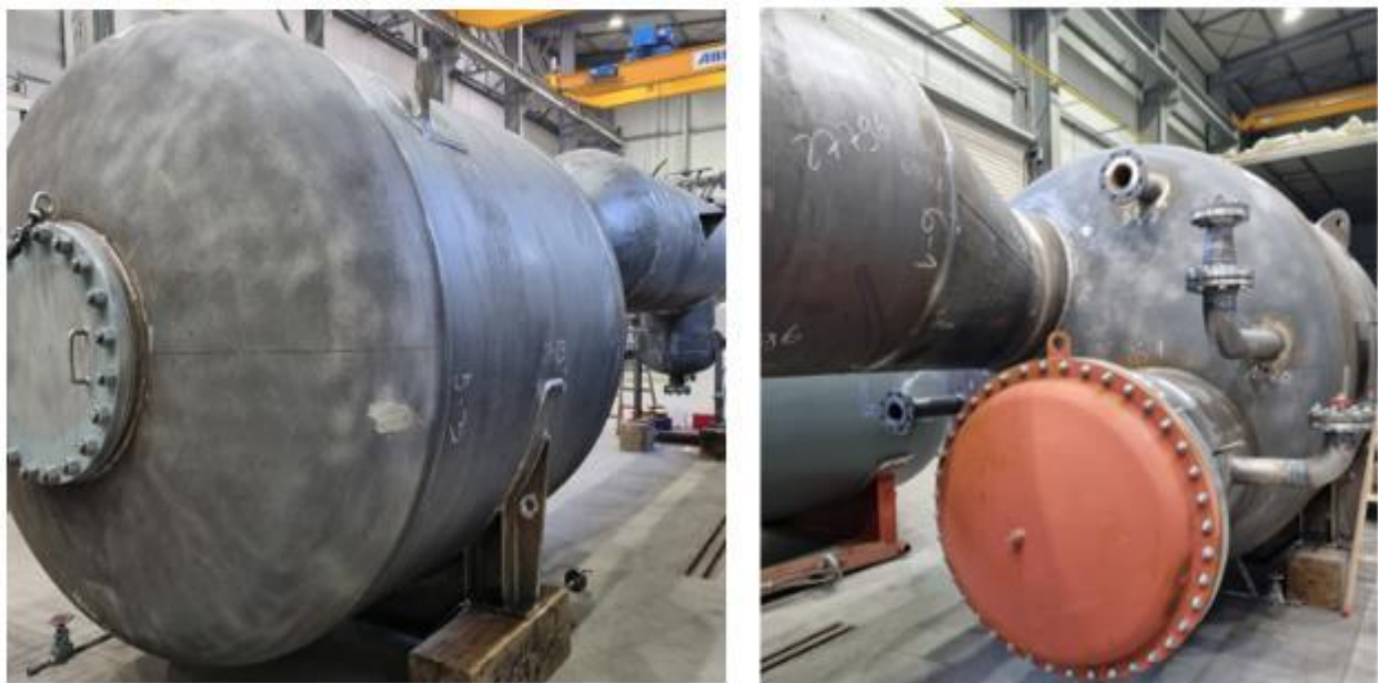
Slika 5.1 Regenerator - izmjenjivač topline [28]
