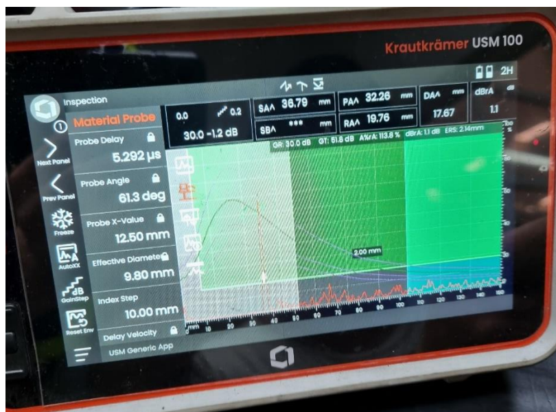
Slika 5.43 Prikaz najvećeg signala kod postavljanja kuta ultrazvučnog snopa [28]
