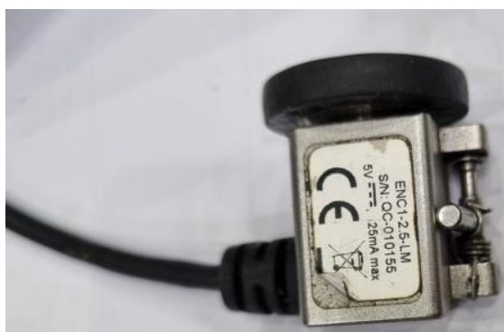
Slika 5.12 Pretvarač položaja ENC1-2.5-LM [28]
