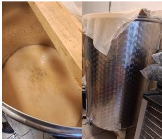
Slika 10: Razvoj gljiva u bačvi za octenu fermentaciju
