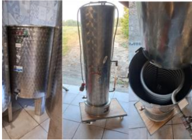
Slika 7: Bačva za sok i pasterizator
