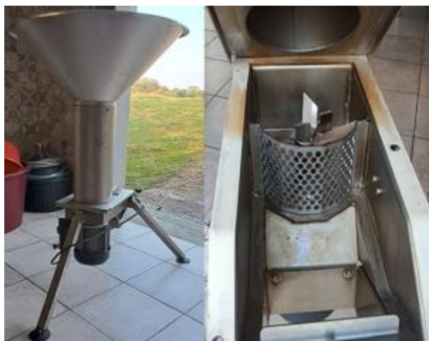
Slika 5: Mlin za mrvljenje jabuka
