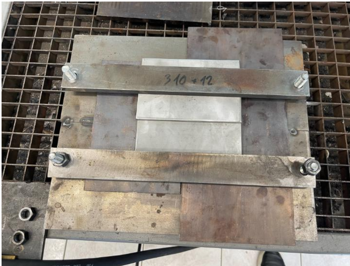
Slika 33. Prikaz pozicioniranog ispitnog uzorka spremnog za zavarivanje [28]
