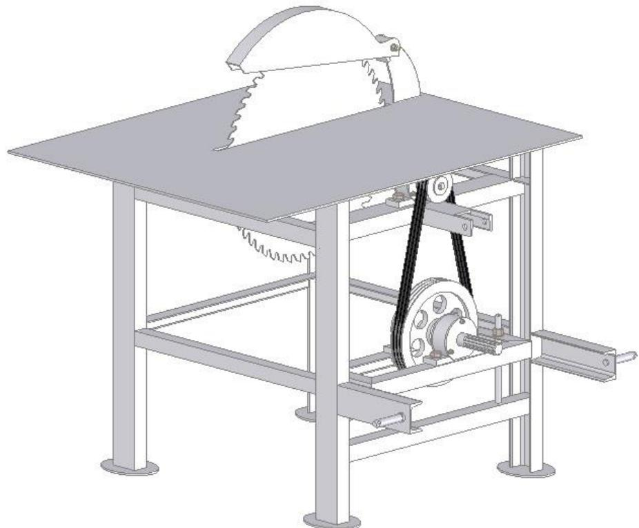
Slika 6.5: Kružna pila na traktorski pogon
