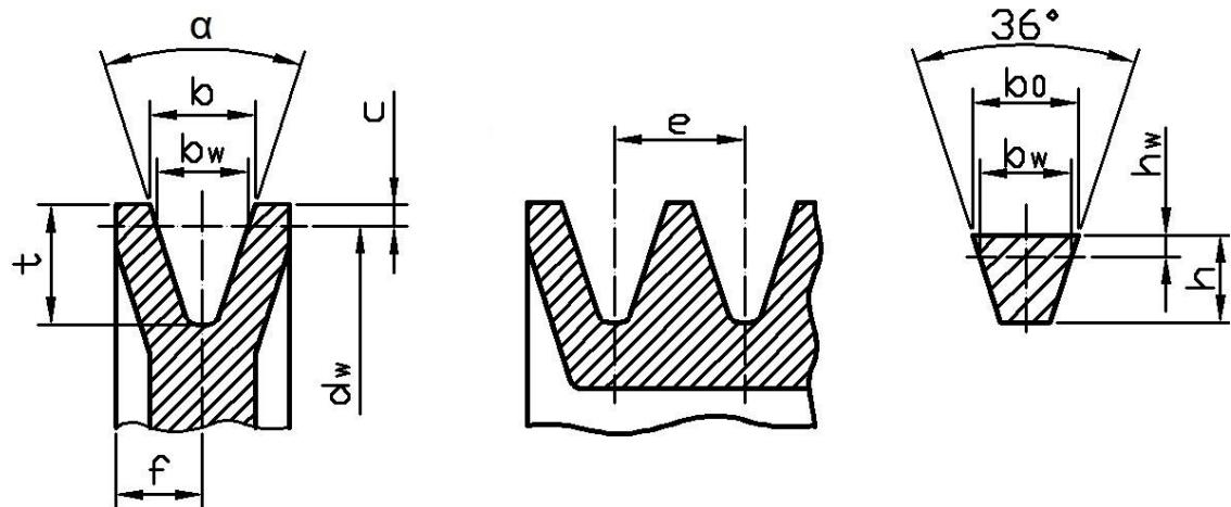
Slika 5.3: Dimenzije profila remenice i uskog klinastog remena [6]
