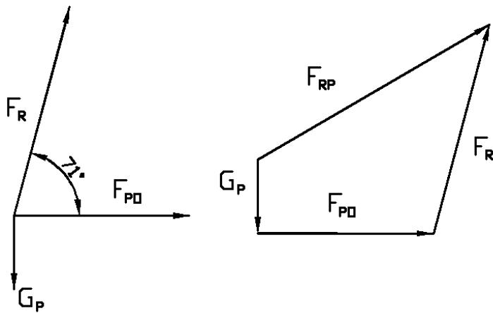
Slika 5.8: Plan položaja sile i poligon sile na pilu
