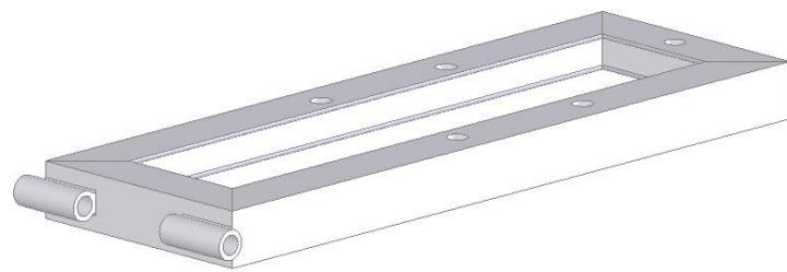
Slika 6.4: Nosač pogonske remenice
