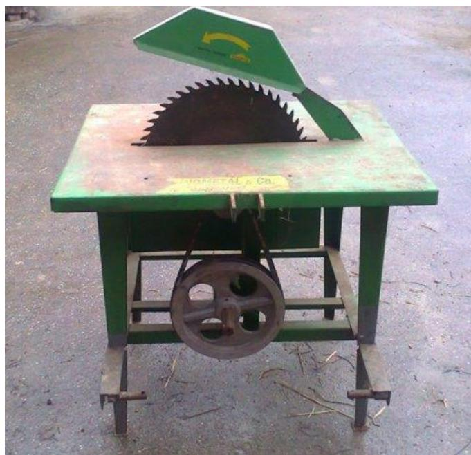
Slika 3.1: Vratila u paralelnom položaju s malim razmakom između osi [2]
