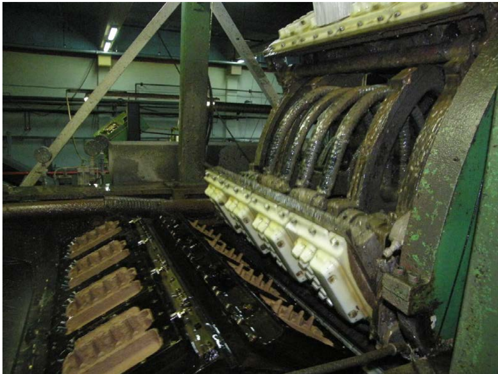
Slika 2.6: Uklapanje usisnog i presnog rotora
