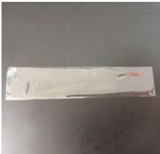
4.18 uzorak za vlačno ispitivanje čvrstoće [25]
