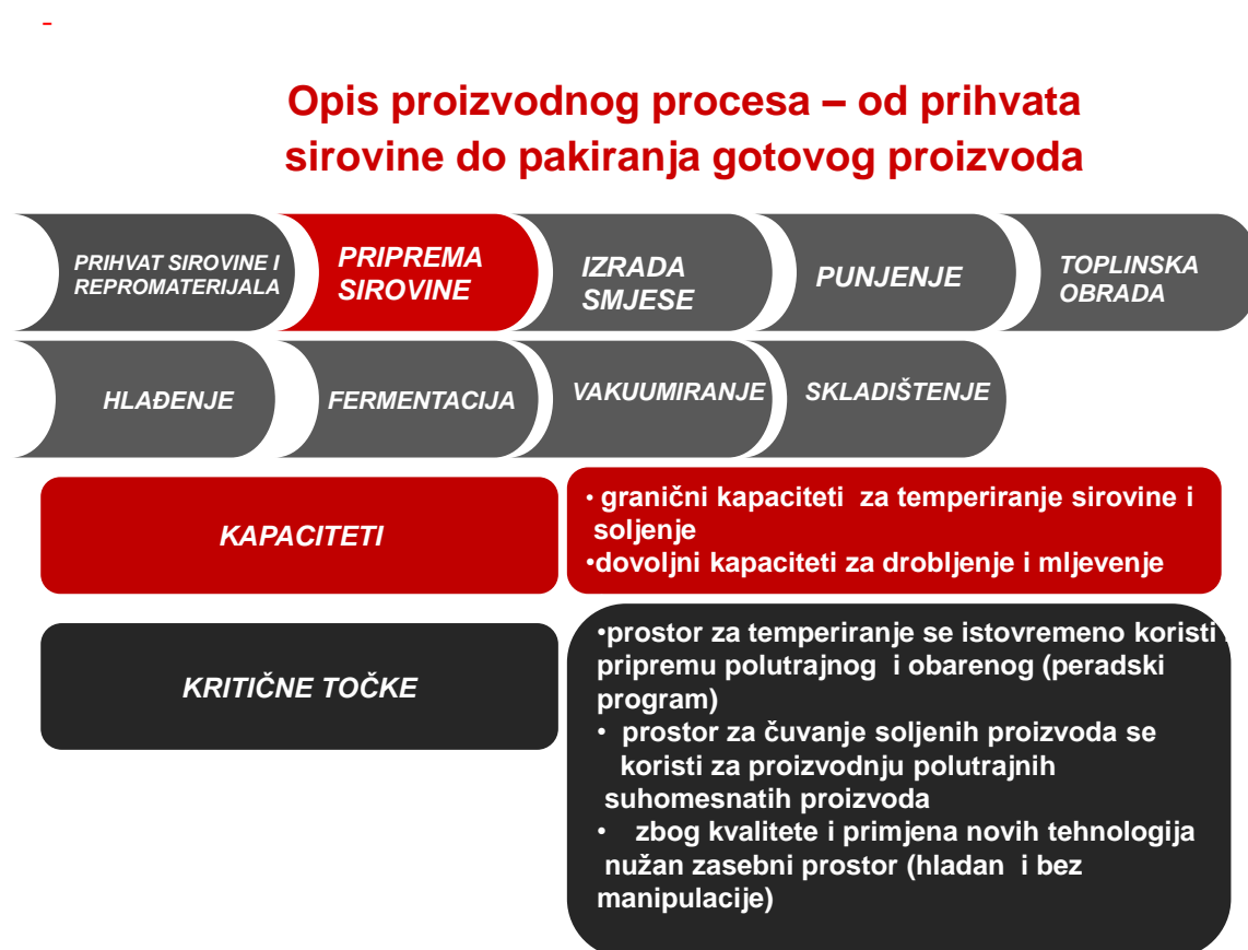
Slika 3.1 Opis proizvodnog procesa - priprema sirovine [7]
