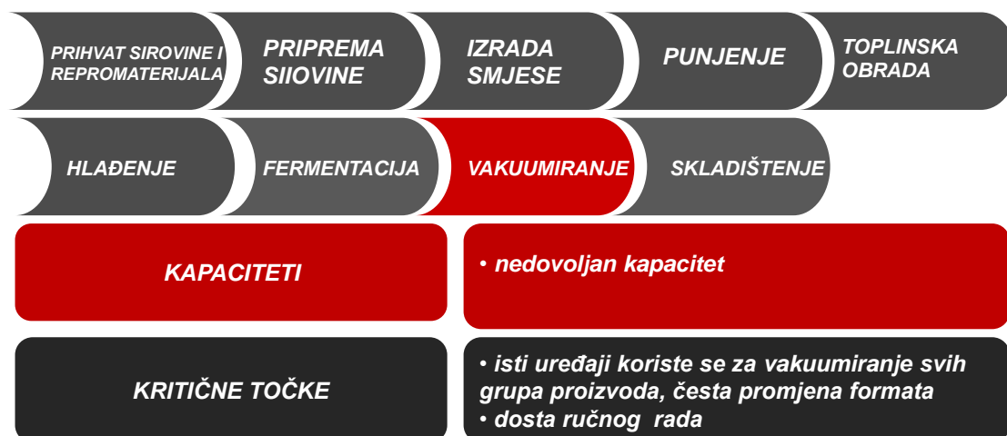
Slika 3.6 Opis proizvodnog procesa - vakuumiranje [7]
