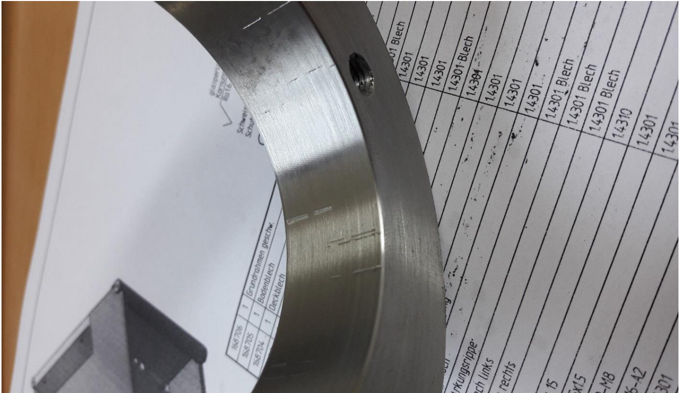
Slika 4.51. Oštećeni provrt pozicije
