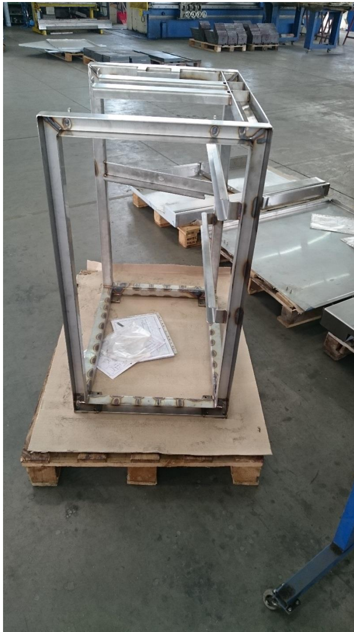
Slika 4.35. Kolica nakon zavarivanja
