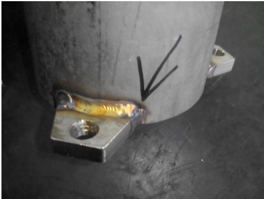
Slika 4.53. Greška kod zavarivanja – rupa na površini zavara
