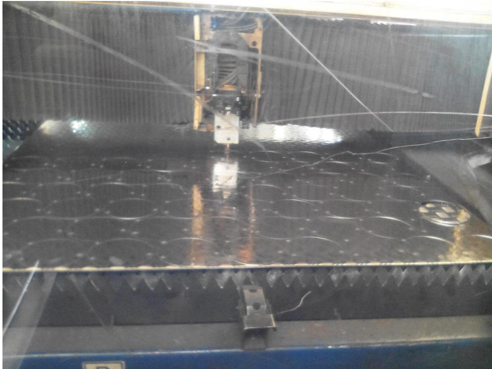
Slika 4.27. Stroj za lasersko rezanje lima u radu
