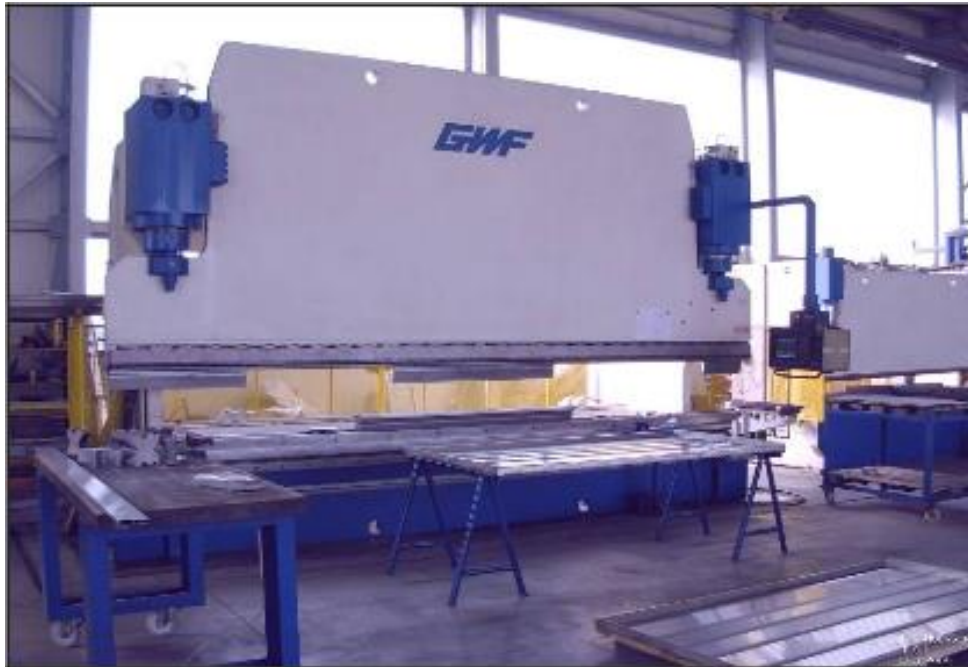
Slika 4.3. ABKANT preša za savijanje lima (veća) [10]
