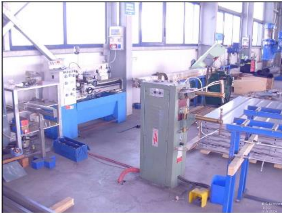
Slika 4.14. Aparat za točkasto zavarivanje (zelene boje)
