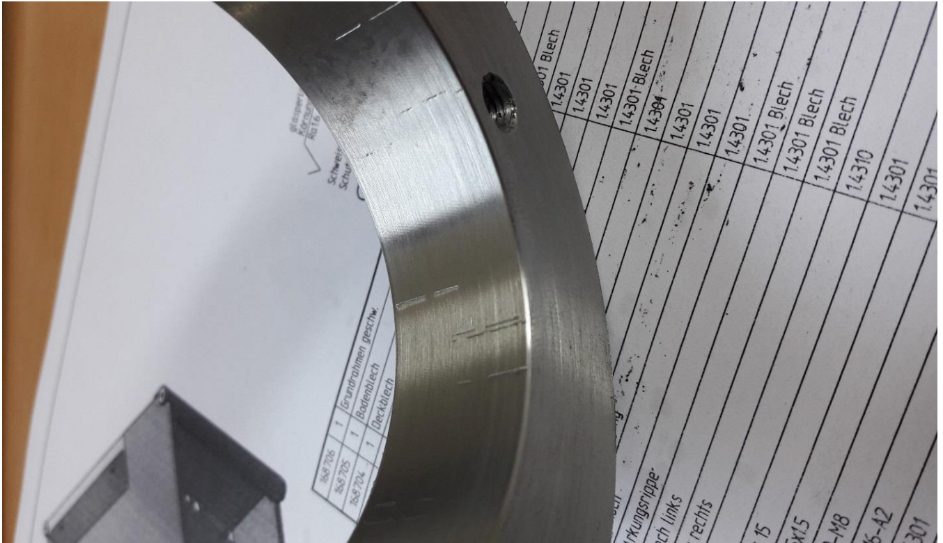
Slika 4.51. Oštećeni provrt pozicije
