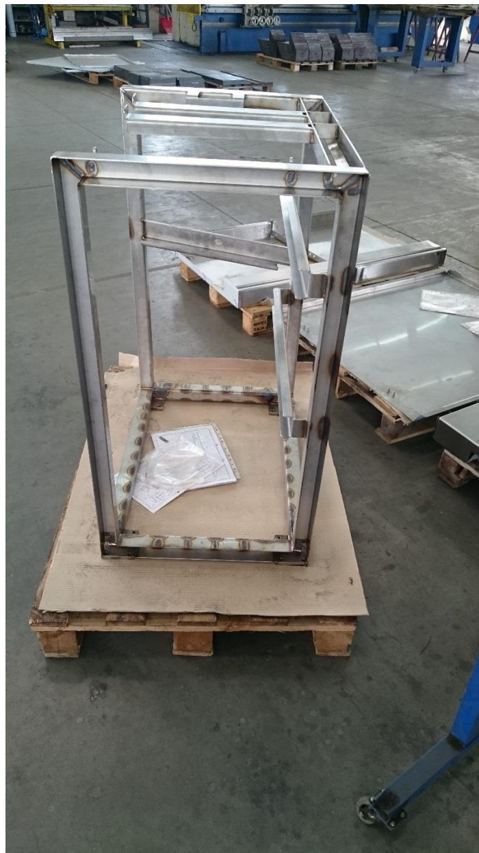
Slika 4.35. Kolica nakon zavarivanja
