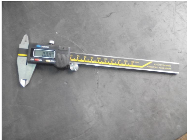
Slika 4.40. Digitalno pomično mjerilo s dubinomjerom
