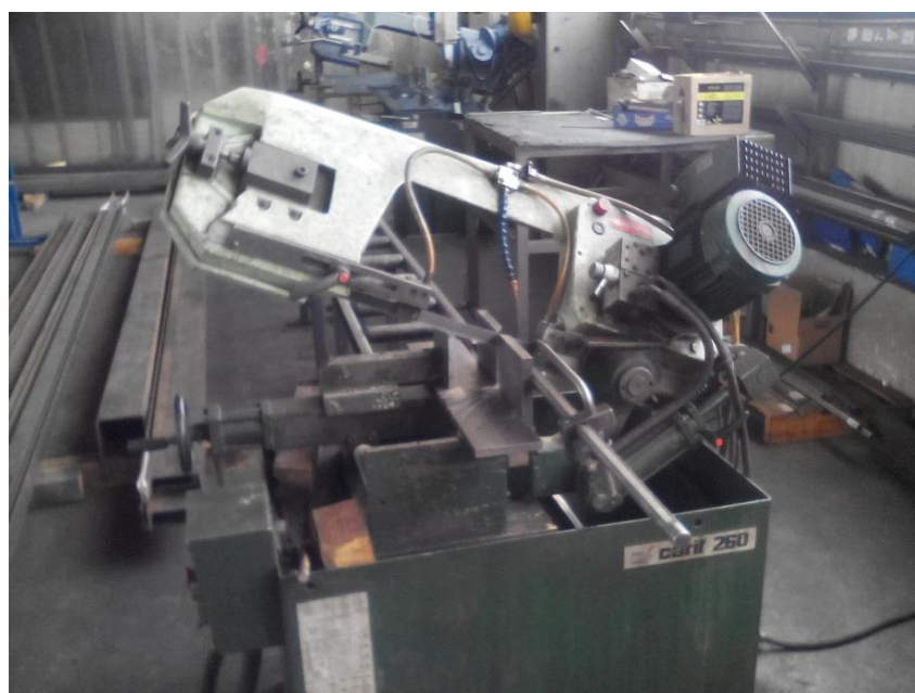
Slika 4.9. Tračna pila Carif 260BM
