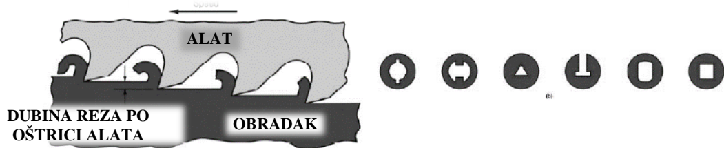
Slika 5.14: Princip obrade iglom za provlačenje (lijevo), neki od oblika profila koji nastaju obradom provlačenja (desno)
