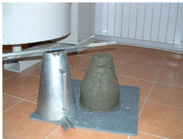
Slika 2.2 Rasprostiranje (HRN EN 12350-5)
