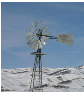
Slika 4.7 Američki tip vjetroturbine [21]
