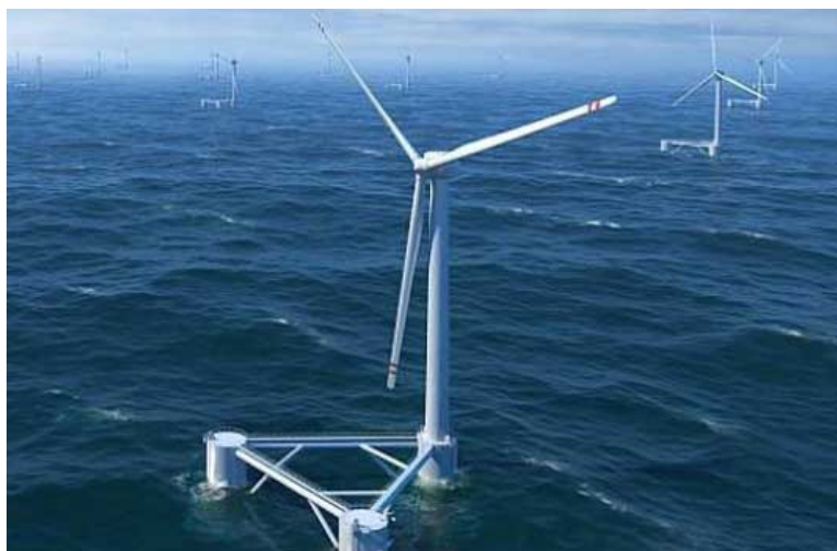
Slika 4.11 Plutajuća morska vjetroturbina [24]
