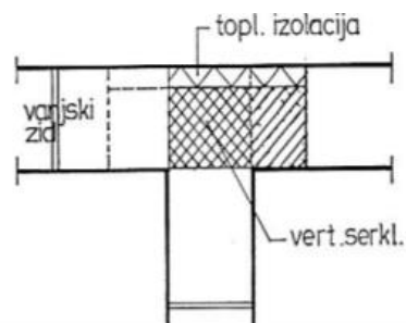
Slika 3.9. Vertikalni serklaž na spoju sa zidom
