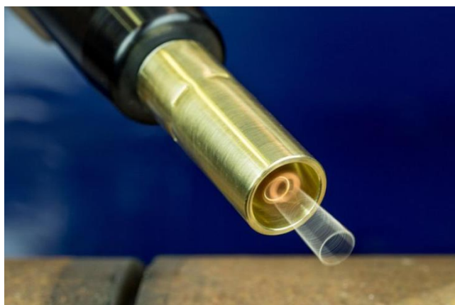
Slika 4.5.2. Izgled rotacije žice kod zavarivanja rotirajućim lukom.[14]
