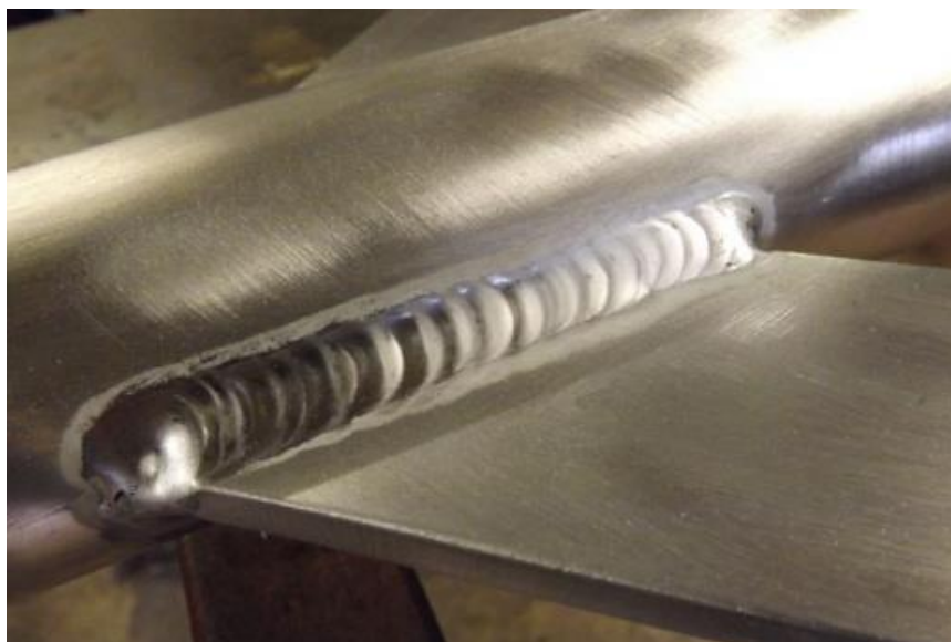
Slika 6.5. Izgled zavara aluminija TIG postupkom zavarivanja.[30]
