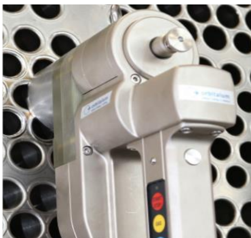
Slika 7.4.4. Glava za orbitalno zavarivanje cijev-cijevna stjena.[38]
