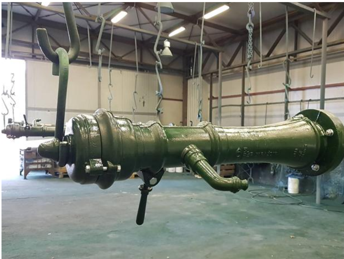
Slika 2.5 Postupak bojenja ručnim raspršivačem [6]
