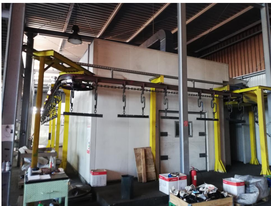
Slika 2.18 Linija za bitumenizaciju uranjanjem [15]
