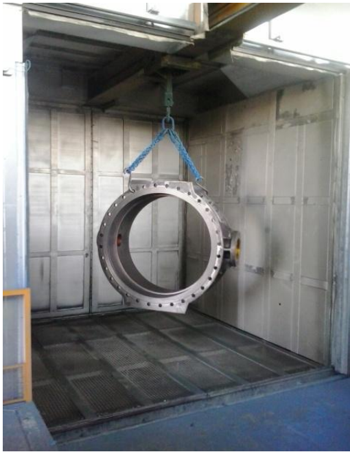
Slika 2.9 Predgrijavanje komada i komora za fluidizaciju [13]
