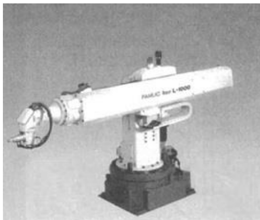
Slika 3. Sferna konfiguracija robota
