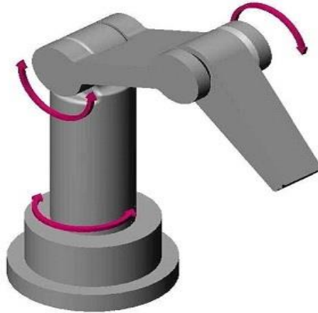
Slika 4. Rotacijska konfiguracija robota
