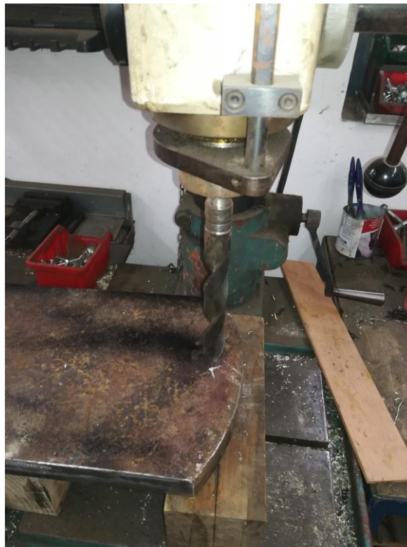
Slika 5.4.. Bušenje postolja na stupnoj bušilici
