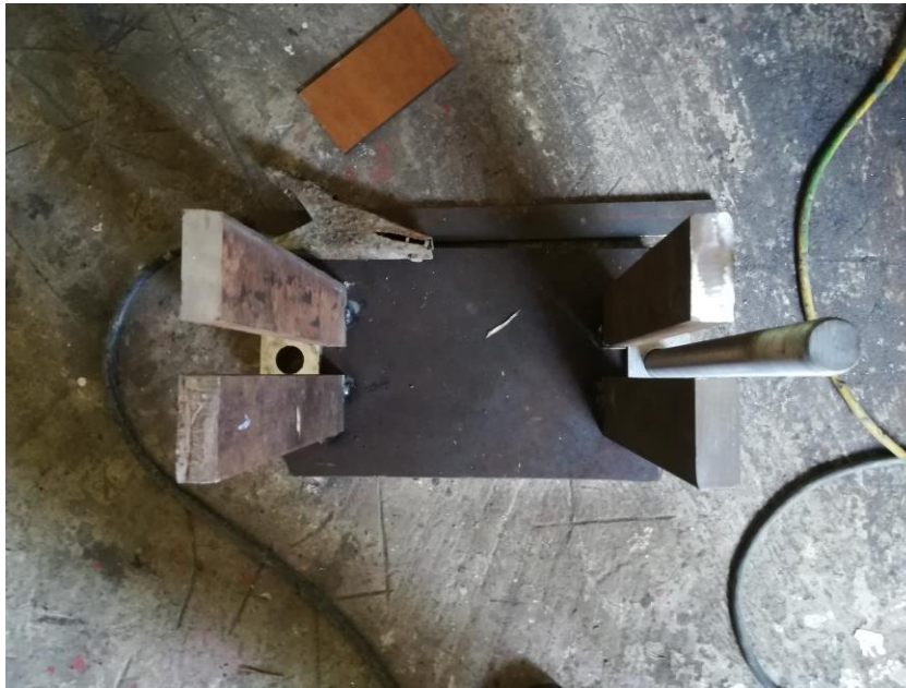
Slika 5.8.. Montaža navojnih vretena
