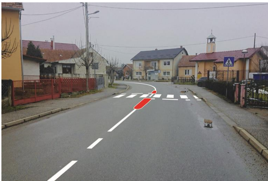
Slika 7.3. Obilježeni pješački prijelaz u Radničkoj ulici u Knežincu Donjem-prikaz predloženog zahvata uzdizanjem pješačkog otoka Izvor: izrada autora
