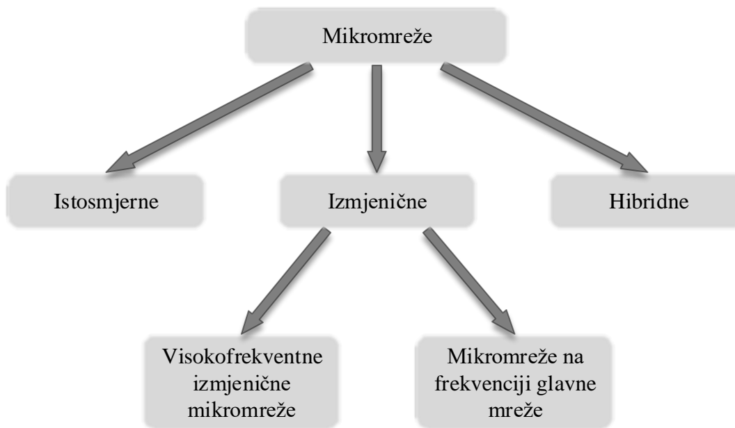
Slika 4.2. Klasifikacija mikromreža prema frekvenciji napona
