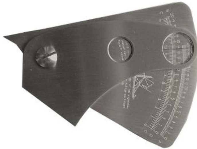
Slika 11.1. Mjerilo s 3 skale za vizualno provjeravanje geometrije zavara[14]
