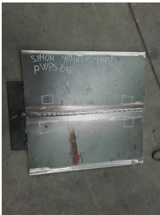
Slika 9.6. Zavaren ispitni uzorak sučeljenog spoja
