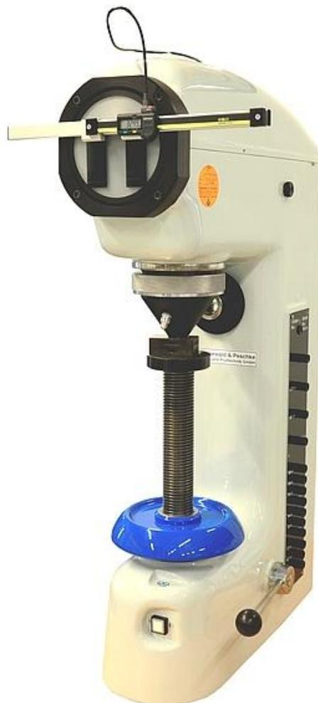
Slika 11.16. Uredaj za mjerjenje tvrdoće (tvrdomjer) HPO-250[19]
