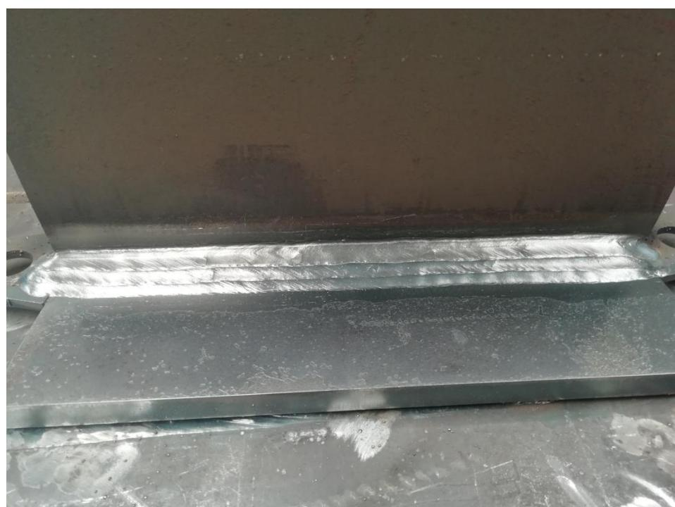
Slika 9.8. Zavaren ispitni uzorak kutnog spoja
