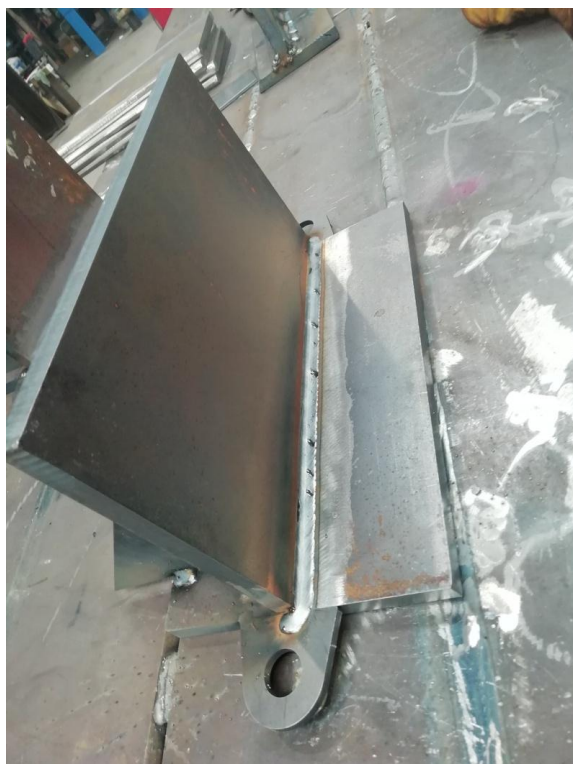
Slika 9.4. Zavaren prvi prolaz kutnog spoja u PB položaju
