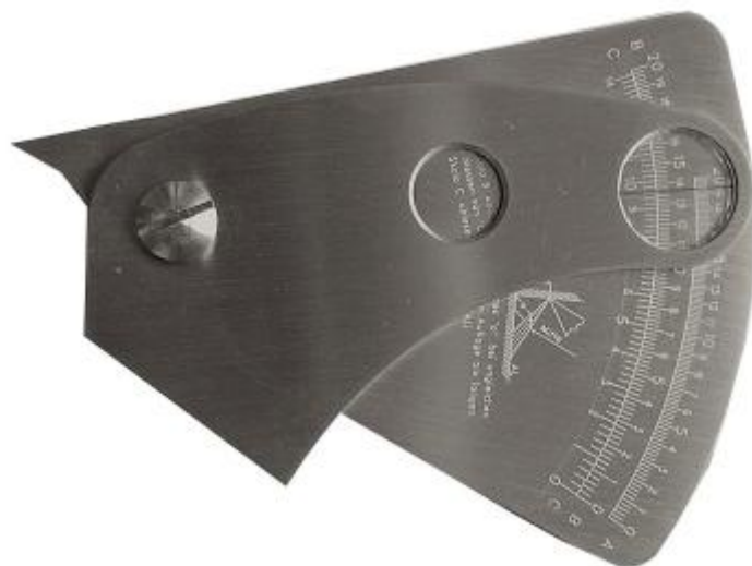
Slika 11.1. Mjerilo s 3 skale za vizualno provjeravanje geometrije zavora[14]
