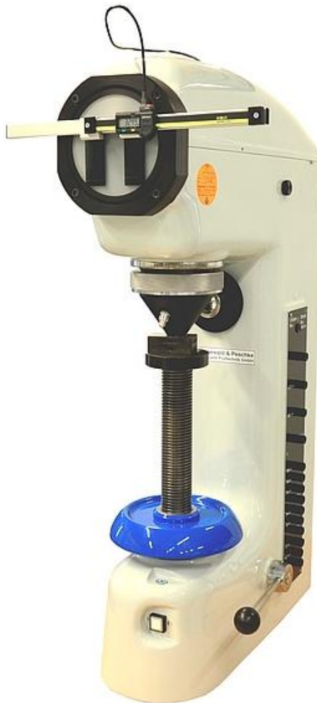
Slika 11.16. Uređaj za mjerenje tvrdoće (tvrdomjer) HPO-250[19]
