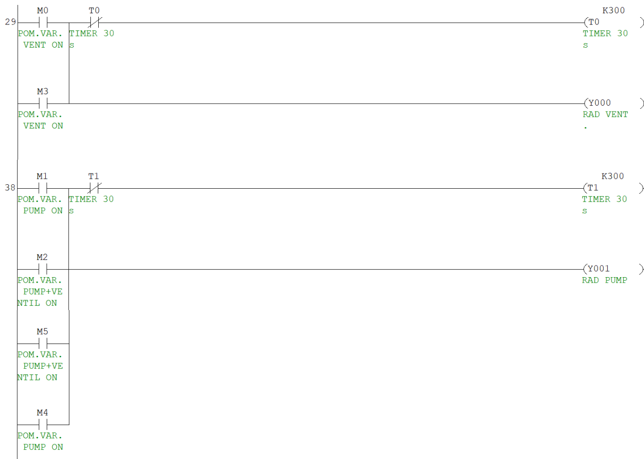
Slika 1.22 Prikaz djela programa sa timerom od 30s za uključenje izlaza Y0.0 (rad ventilatora) i Y0.1(rad pumpe)
