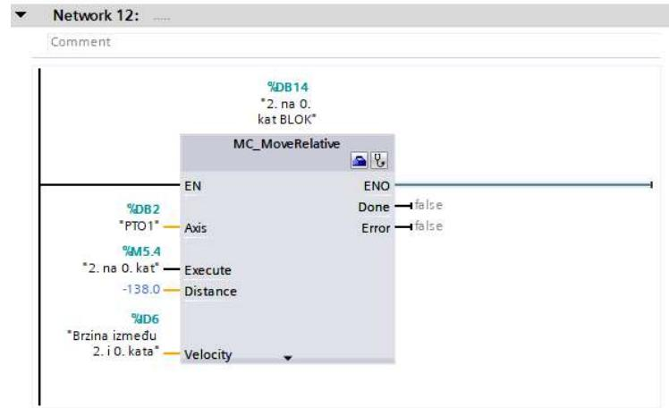
Slika 6. 13 Konfiguriranje relativnog pozicioniranja s 2. kata na 0. kat
