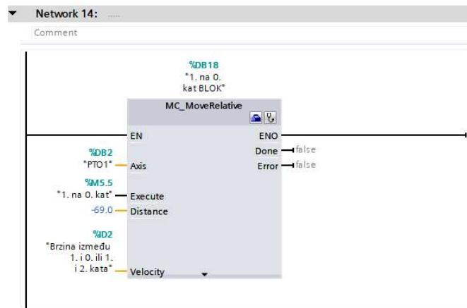
Slika 6. 15 Konfiguriranje relativnog pozicioniranja s 1. kata na 0. kat
