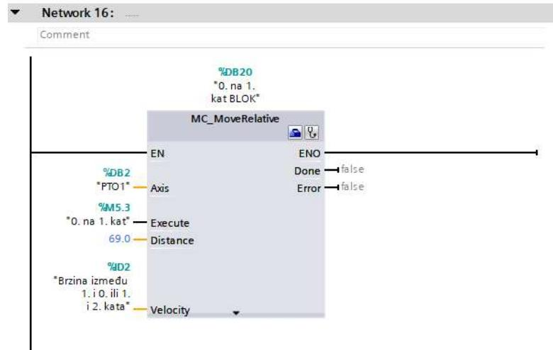
Slika 6. 17 Konfiguriranje relativnog pozicioniranja s 0. kata na 1. kat
