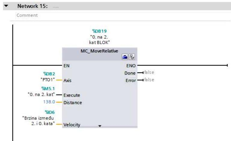
Slika 6. 16 Konfiguriranje relativnog pozicioniranja s 0. kata na 2. kat
