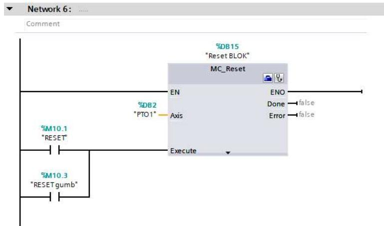
Slika 6. 6 Blok za resetiranje konfiguracije PTO-a
