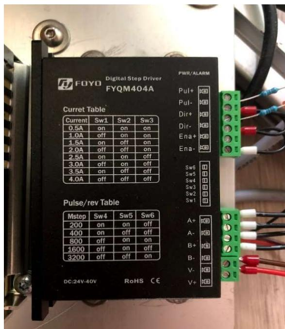
Slika 4. 6 Korišteni driver za pokretanje step motora
