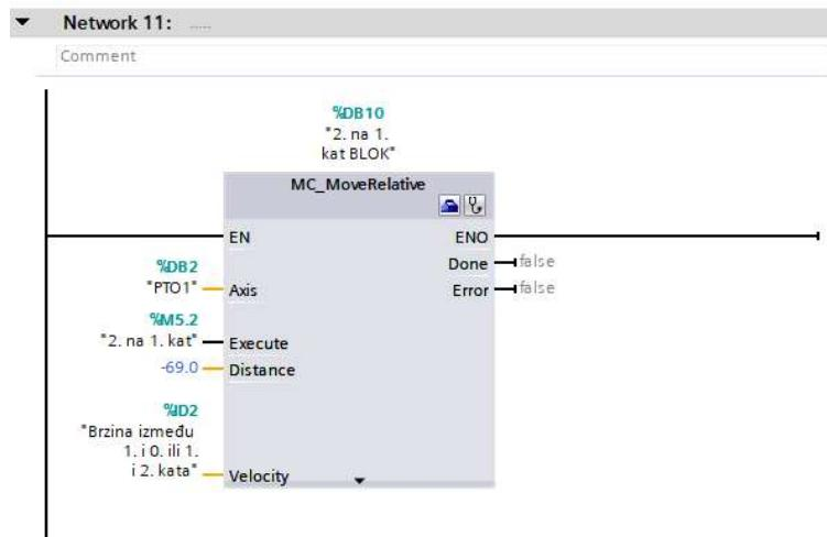
Slika 6. 12 Konfiguriranje relativnog pozicioniranja s 2. kata na 1. kat
