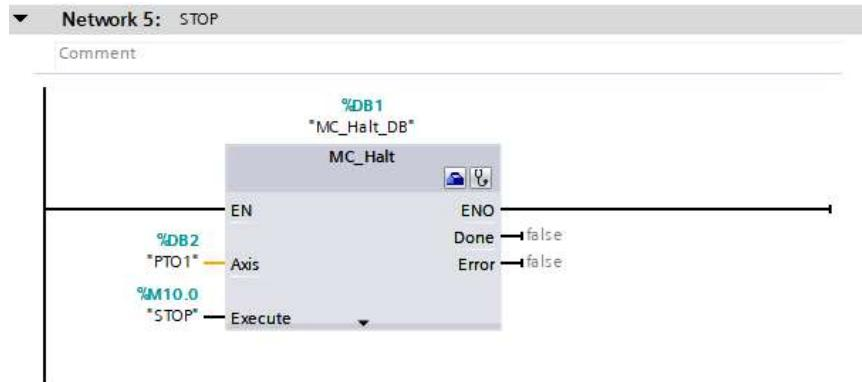
Slika 6. 5 Konfiguriranje bloka za zauzavljanje step motora
