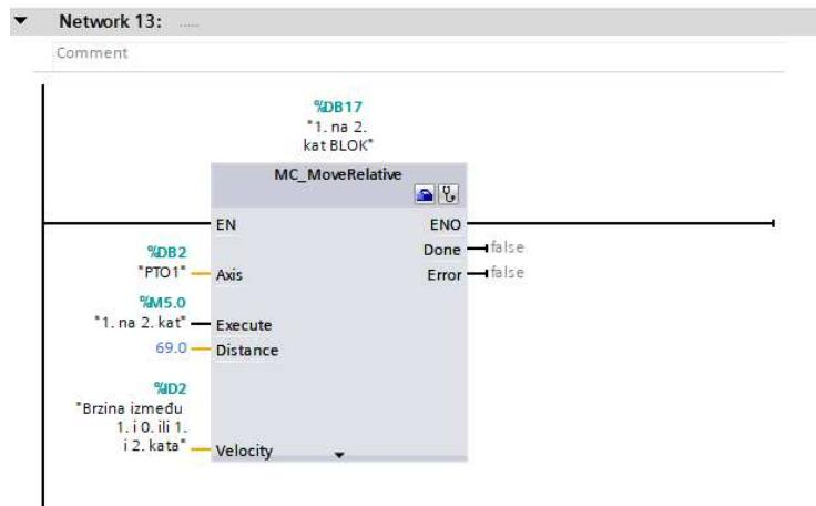
Slika 6. 14 Konfiguriranje relativnog pozicioniranja s 1. kata na 2. kat
