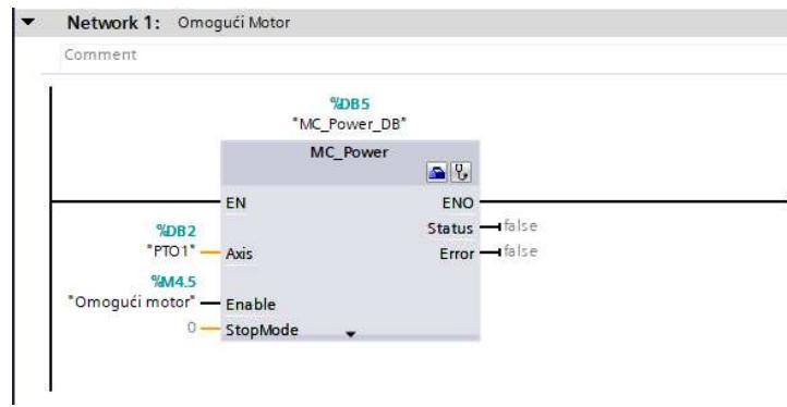
Slika 6. 1 Blok za omogućiti motor
