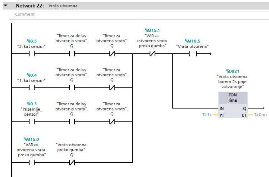
Slika 6. 23 Konfiguriranje otvaranja vrata lifta
