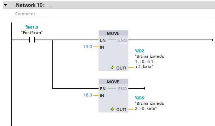
Slika 6. 11 Postavljanje početne vrijednosti (brzine) step motora
