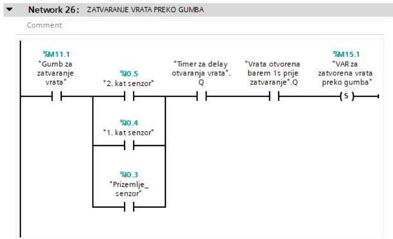
Slika 6. 27 Konfiguiranje zatvaranja vrata preko gumba
