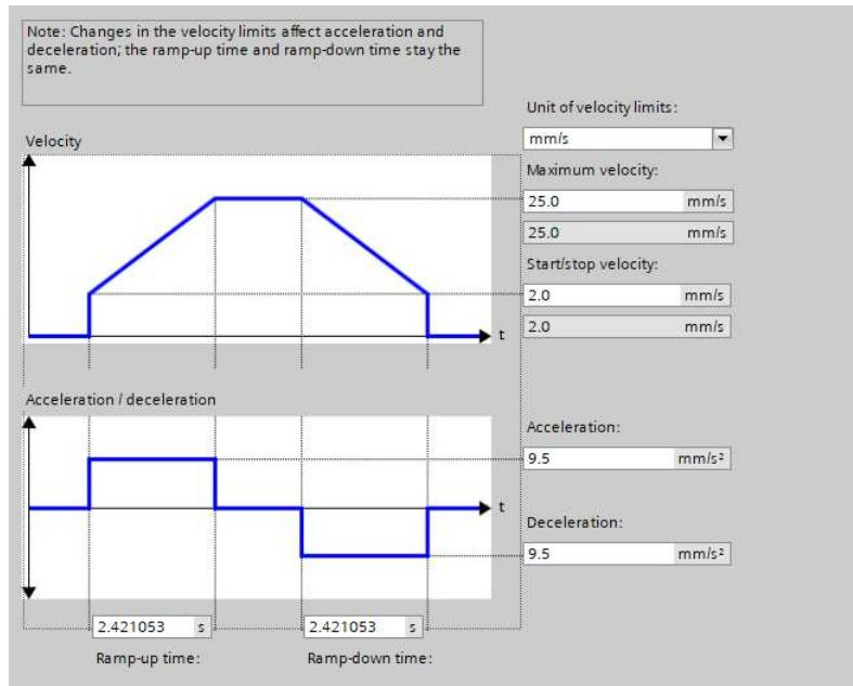
Slika 4. 9 Prikaz konfiguracije linearног ubrzanja
