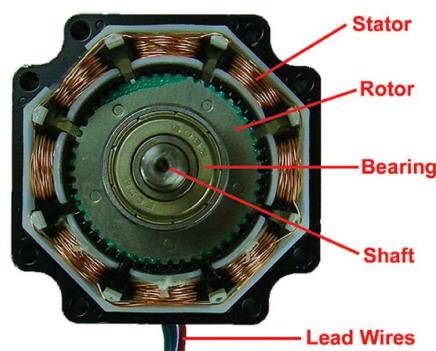
Slika 4. 5 Prikaz unutrašnjosti step motora [7]
