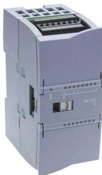
Slika 3. 4 Primjer analognog modula za PLC S7-1200 [6]
