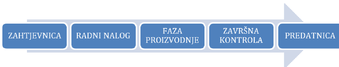
Slika 14: Shematski prikaz tokova materijala
