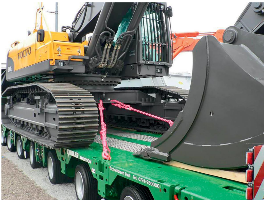
Slika 3: Primjer ispravnog dijagonalnog povezivanja stroja na labudici
