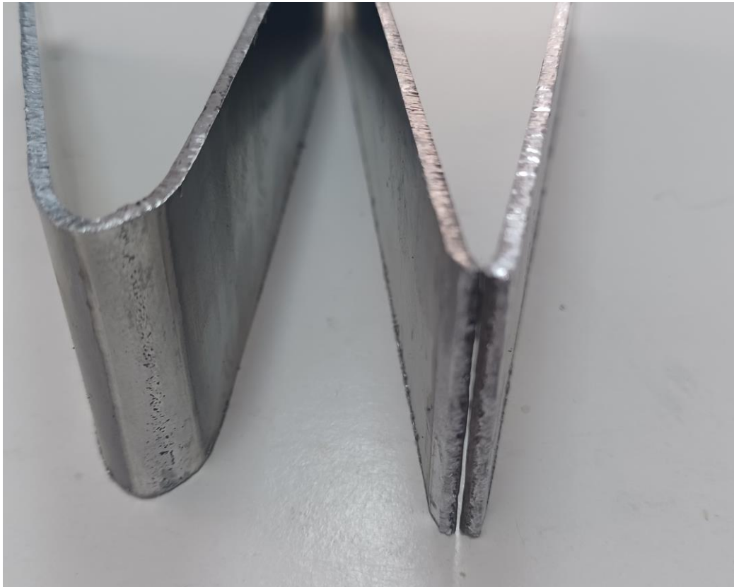
Slika 4.12. Prikaz rezultata ispitivanja savijanjem lica i korijena epruvete 1.
