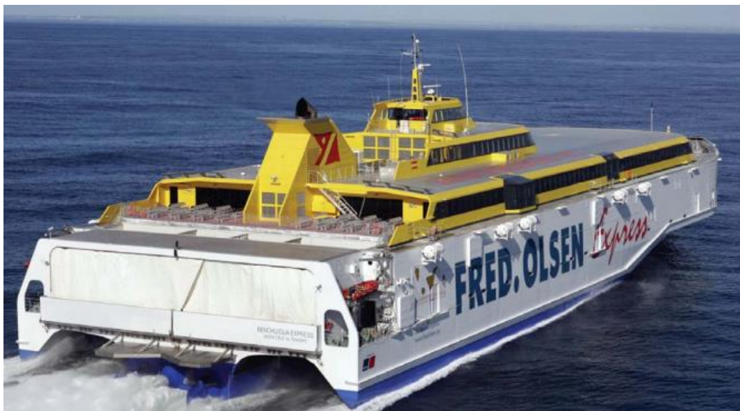
Slika 2.3. Aluminijski brod „Benchijigua Express“ dužine 127 m [16]
