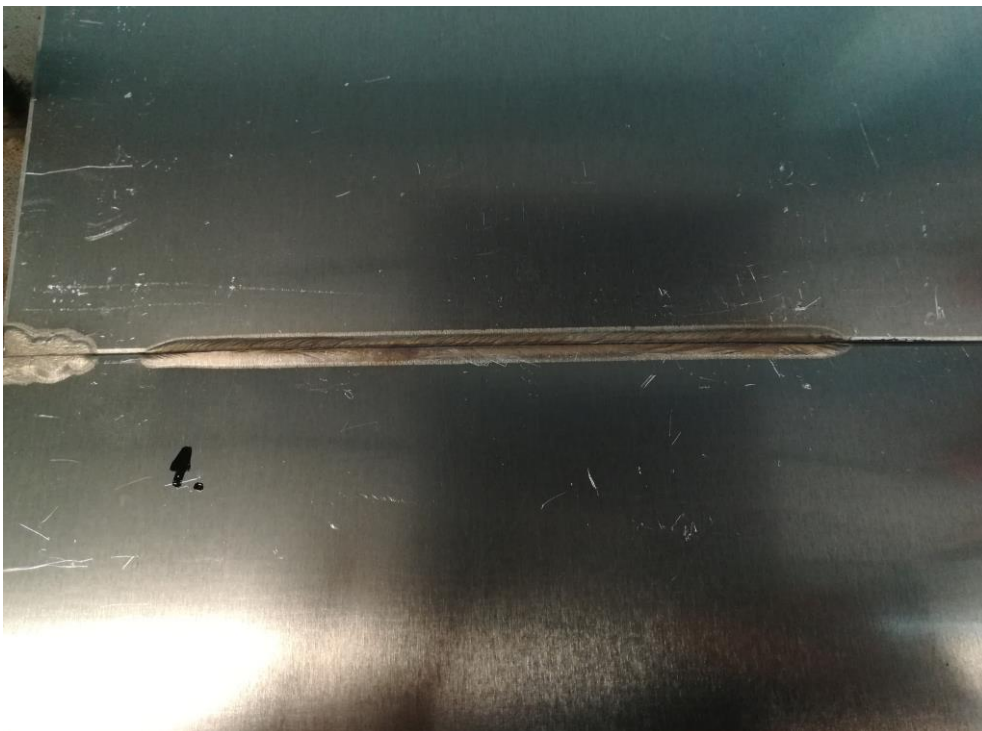
Slika 4.5. Korijen zavora prvog uzorka
