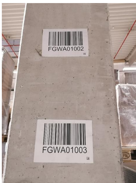
Slika 10: Barkodovi za skeniranje skladišne lokacije
