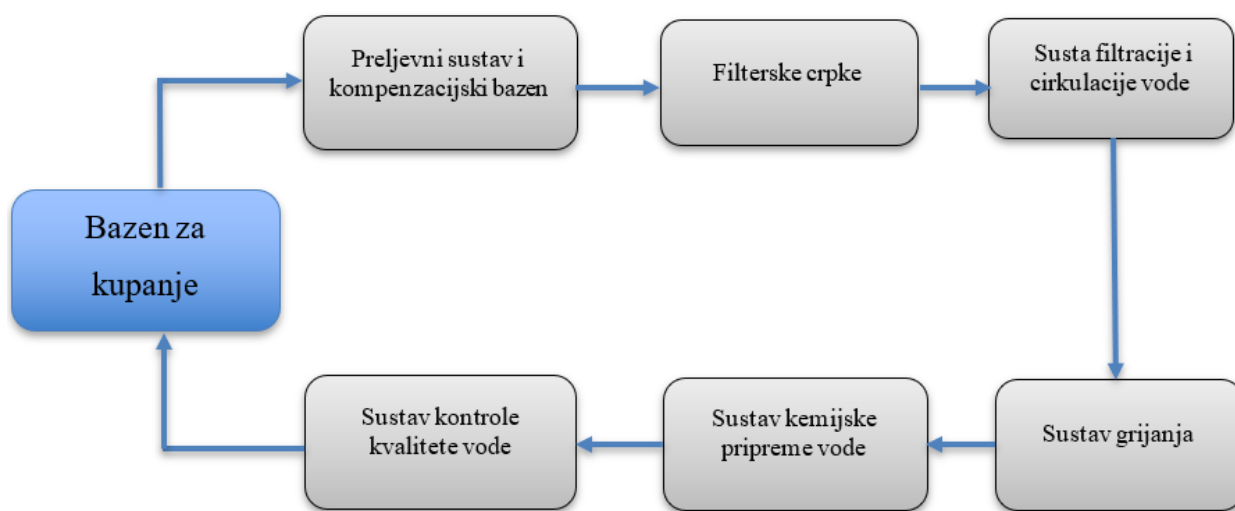
Slika 3.3 Tijek sustava za pripremu vode (vlastiti izvor)
