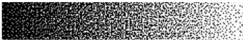
Slika 7.3 Frekventno modulirani (FM) raster
