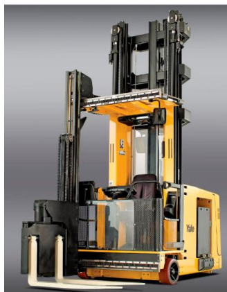
Slika 5.1.: Viličar sa zakretnim vilicama Yale serije MTC [34]
