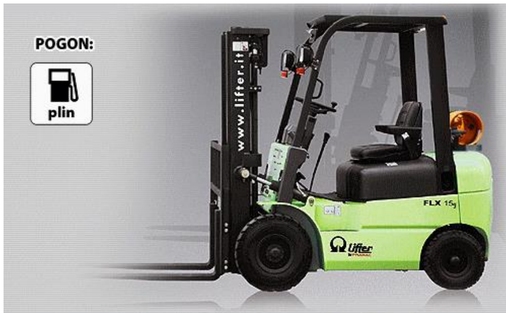
Slika 2.12.: Viličar s plinskim pogonom [10]
