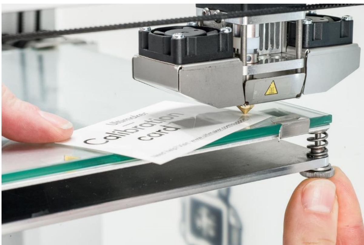
Slika 5.2.5 Ručno ravnanje podloge
