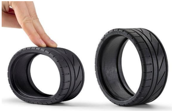
Slika 5.3.1 Primjer primjene TPU filamenta
