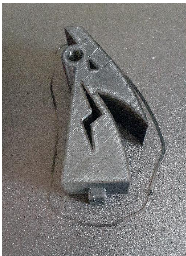
Slika 7.17 3D ispisani bazni dio luka
