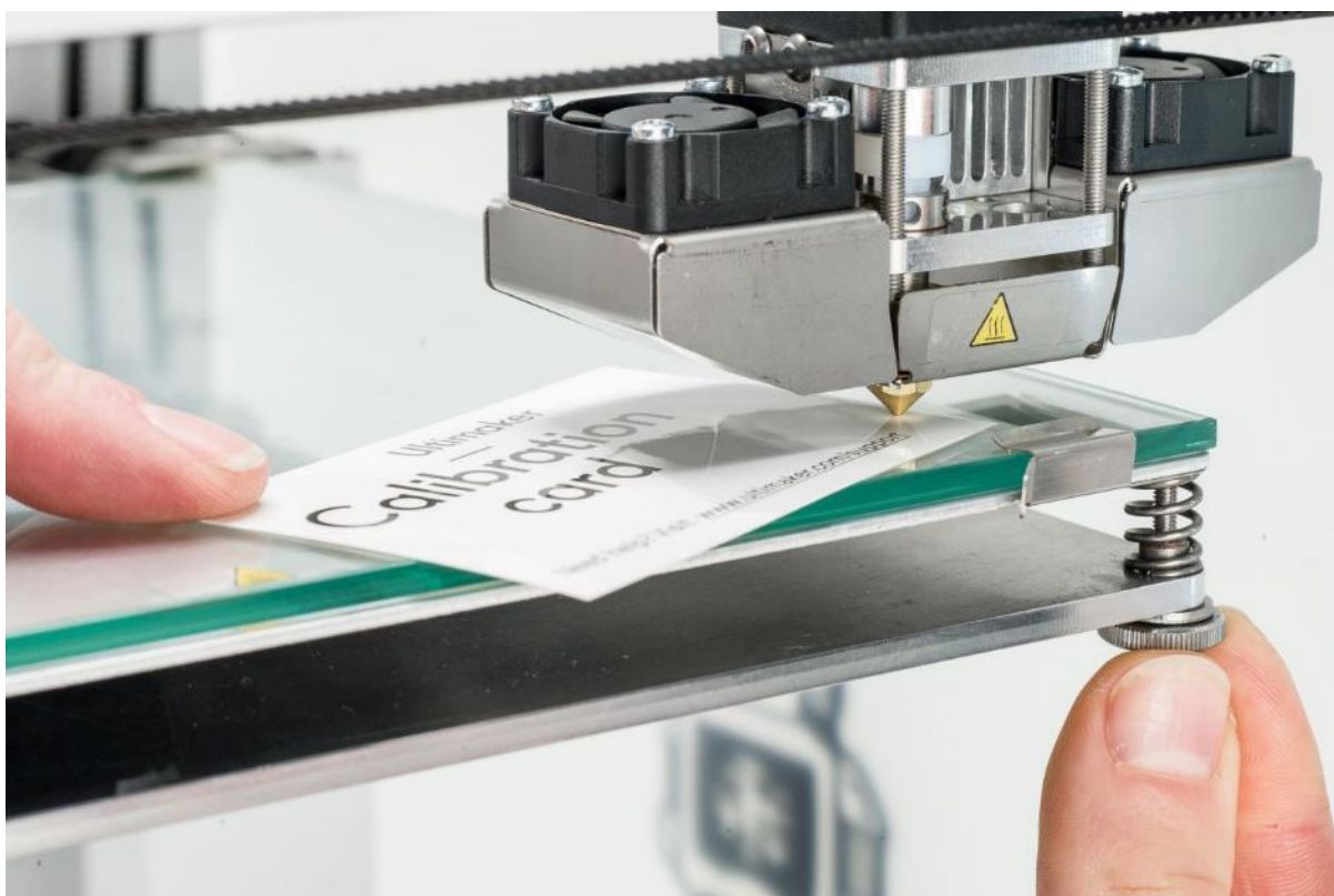
Slika 5.2.5 Ručno ravnanje podloge
